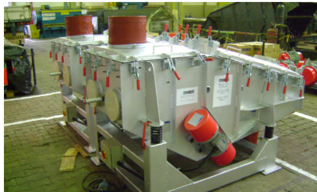
Aplicação especial de motovibradores para peneiramento de materiais quentes. Special application of vibrators for hot materials screening.
