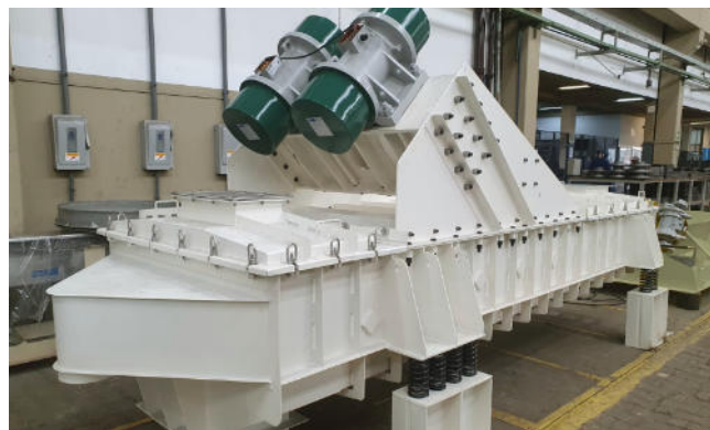
Peneira VELOPEN 14.35-1 para peneiramento de até 40 t/h de açúcar cristal com de tela Mesh 10.
