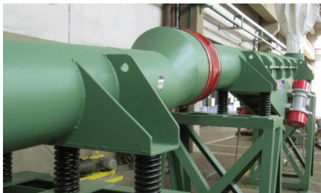
Tubos vibratórios VELOCAN conectados em série. O acionamento é feito por 2 motovibradores VIMOT de 1,3 kW cada. Vibrating VELOCAN tubes connected working in line. They are driven by 2 vibratory motors VIMOT of 1.3 kW each.
